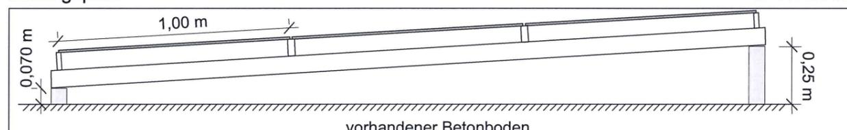
Technischer Schnitt der PV - Module
