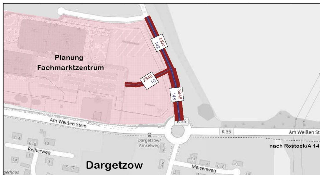
Bild 4: Durchschnittliche tägliche Verkehrsstärke Prognose 2030 in Kfz/24h
