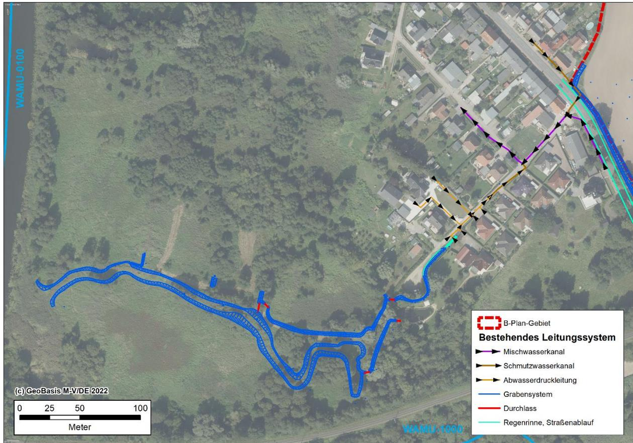
**Abbildung 4-1: Überblickhafte Darstellung des bestehenden Entwässerungs- und Grabensystems im Wiesenweg sowie den Warnowwiesen in Kessin**
