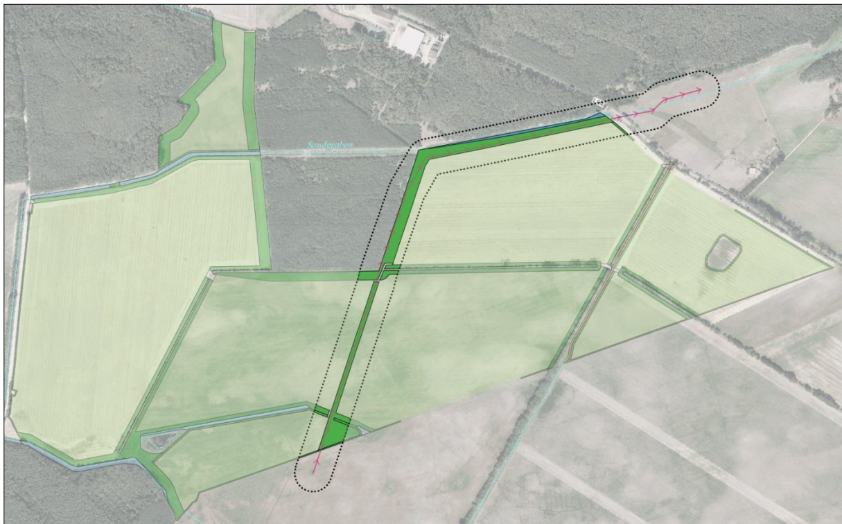
Abb. 27: Maßnahme E2 in 50 m-Wirkzone um Freileitung
