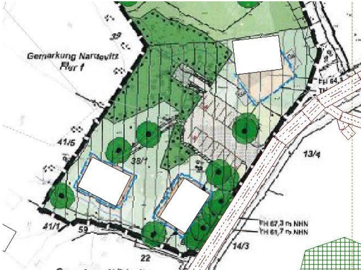
Abbildung 15-4, Verschiebung und Drehung der WE an den bebaubaren Rand des Plangebiets
