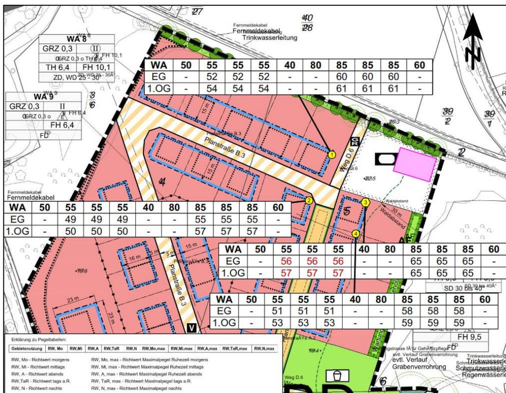
Abbildung 4: Berechnungsergebnisse gemäß 18. BImSchV, Lärmschutzvariante I
