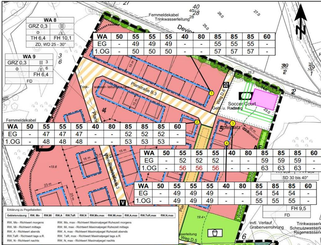
Abbildung 5: Berechnungsergebnisse gemäß 18. BImSchV, Lärmschutzvariante II
