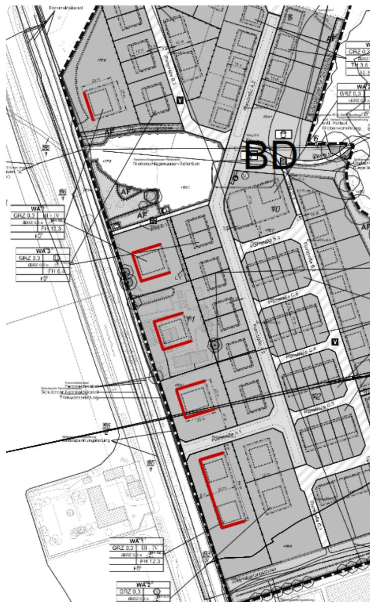
Abbildung 8: Fassadenbereiche für eine lärmoptimierte Grundrissgestaltung
