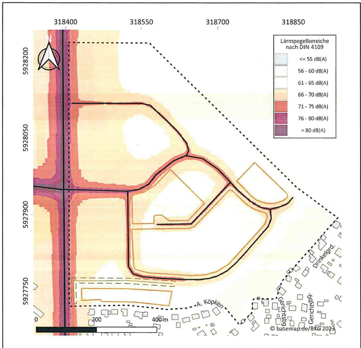
Abbildung 19: Lärmpegelbereiche für Mischgebiete nach DIN 4109-1 (Höhe 2 m)
