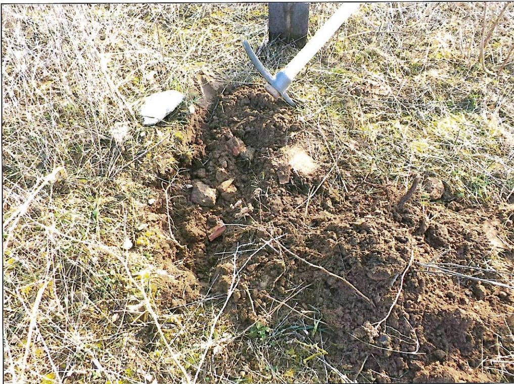
**Abbildung 1.18-3 mit Ziegelmauerwerksbruch durchsetztes Erdreich**
