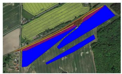
Abbildung 25: Empfohlener Blendschutz entlang der Bahntrasse und Bundesstraße (1) in Gelb, von potenzieller Blendung betroffenes Sichtfeld in Rot, betroffener Streckenabschnitt in Orange
