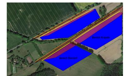
Abbildung 26: Empfohlener Blendschutz entlang der Bahntrasse und Bundesstraße (1) in Gelb, von potenzieller Blendung betroffenes Sichtfeld in Rot, betroffener Streckenabschnitt in Orange
