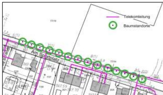
**Abbildung 7:** Überlagernde Darstellung von Telekommunikationslinien und Baumstandorten (entsprechend Telekom und Baumeinmessung)
