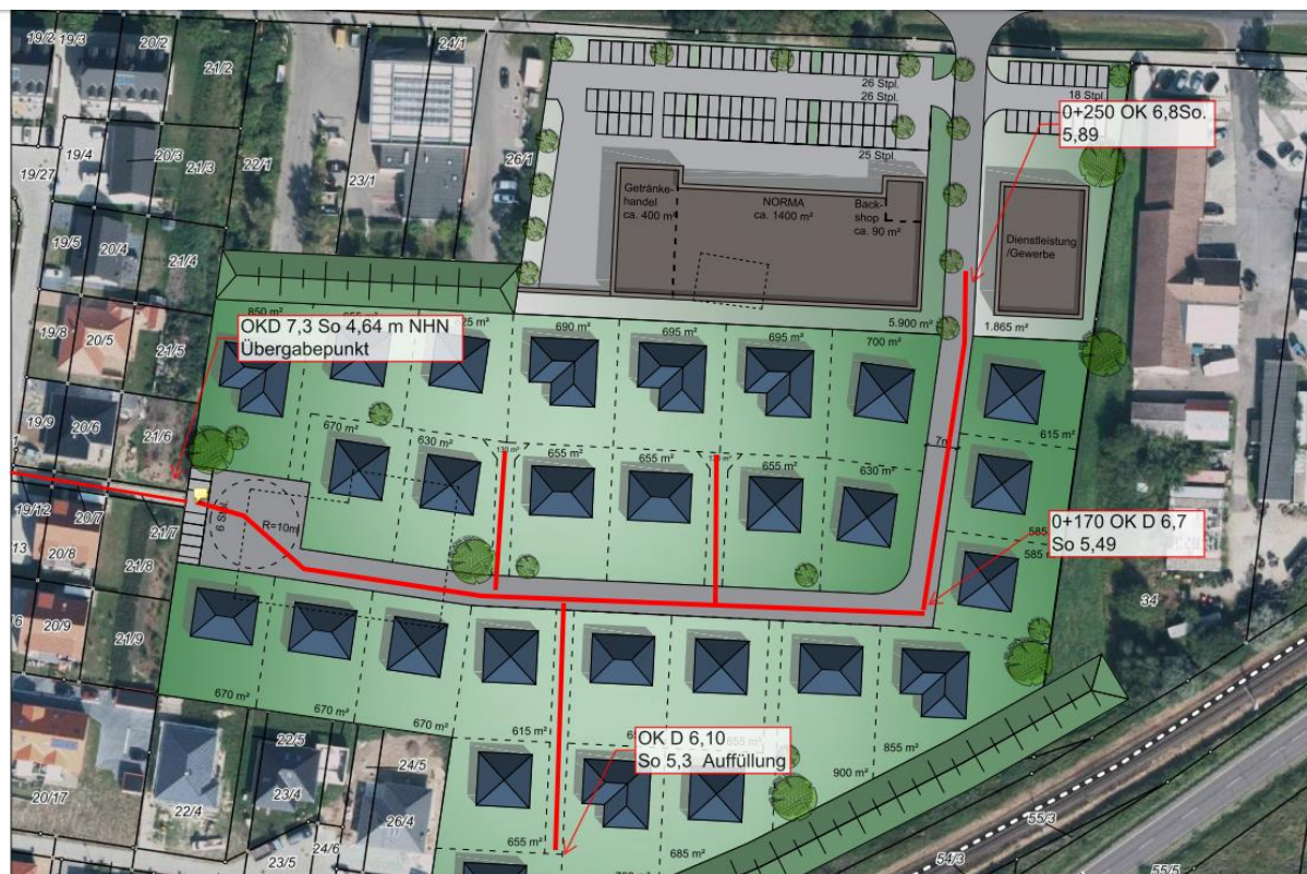
Bild 7: Darstellung Schmutzwasserleitung (rote Linie) - Stand Mai 2019
