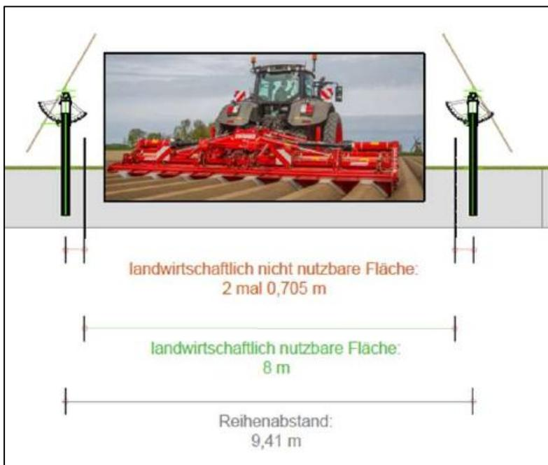
Abbildung 3 Landwirtschaftlich nutzbare Fläche und Reihenabstand für die „Agrar-Photovoltaikanlage an der Bahn Louisenfeld“
