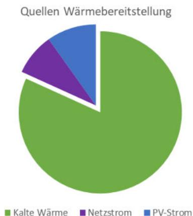
Abb. 10: Anteile Energieträger Bauabschnitt 1 mit Sondenfeld
