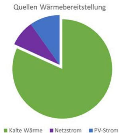
Abb. 14: Anteile Energieträger Bauabschnitt 1 mit Kollektorfeld
