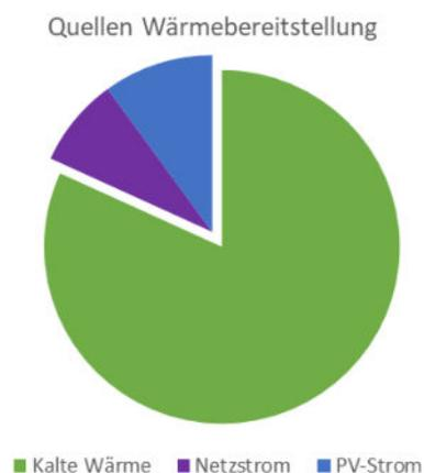
Abb. 18: Anteile Energieträger Bauabschnitt 2 mit Sondenfeld
