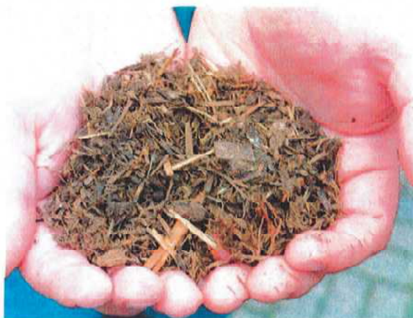
Separierter Gärrest nach der Trocknung, hohes Porenvolumen, Dichte ca. 160Kg/
