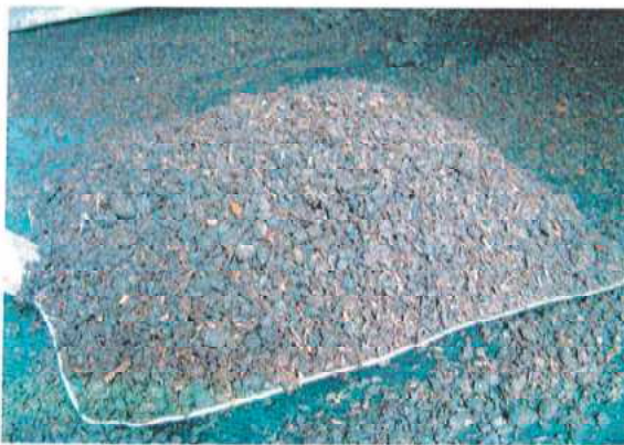
Getrockneter Gärrest (Rückmischverfahren), geringes Porenvolumen, Dichteca. 360 Kg/m 3
