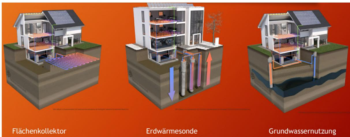
Abbildung 10: Systeme zur Erdwärmenutzung (Popp 2021)<sup>5</sup>
