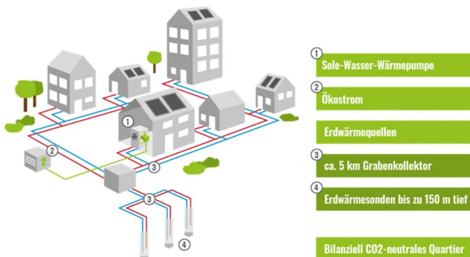
Abbildung 18: Funktionsweise eines kalten Nahwärmenetzes (Stadtwerke Troisdorf<sup>11</sup>)
