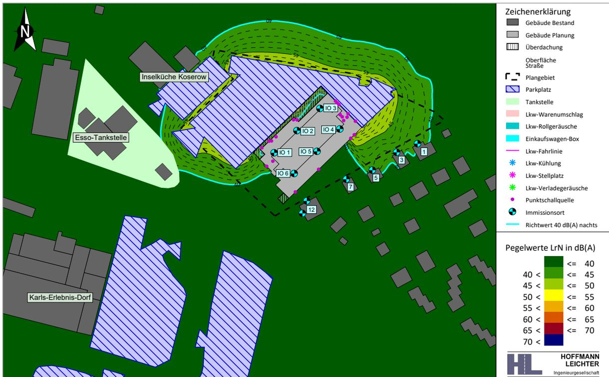
Abbildung 6-2 Isophonenkarte in 5 m Höhe über Gelände | Beurteilung nach TA Lärm | nachts, 22:00 - 06:00 Uhr | mit Schallschutzmaßnahme
