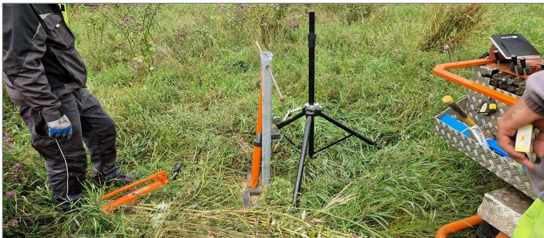
Bild 2: Vertikaler Zugversuch
