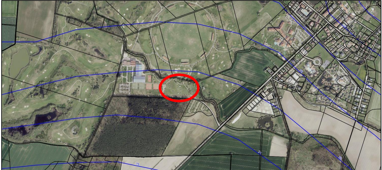
Abbildung 1: Grundwasserhöhengleichen (Grundwasserfließrichtung blau skizziert)
