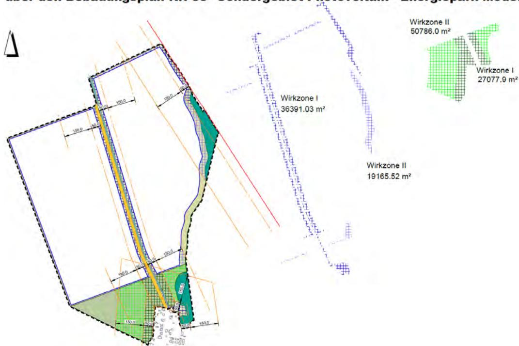
Abbildung 21: Ermittlung und Darstellung der in den Wirkzonen umgebender Störquellen liegenden Flächenanteile der Randflächen und der Grünfläche Süd.
