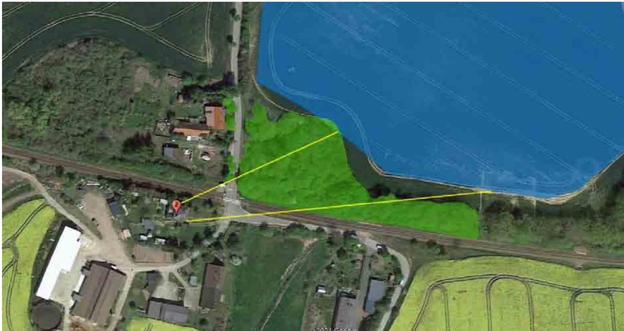
Abbildung 22: Bewuchs (grün dargestellt) als natürlichen Sichtschutz zwischen PV-Anlage B und OP2. Die gelben Linien stellen die maximal möglichen Winkel der Blendreflexionen ausgehend von der PV-Anlage dar
