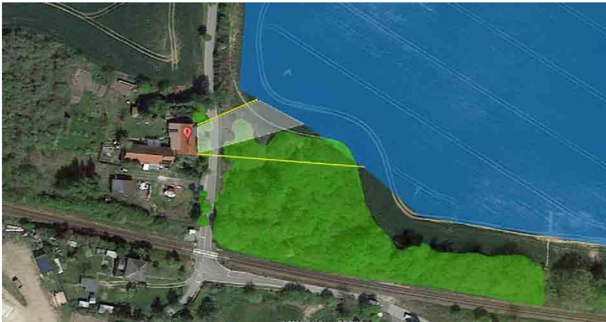
Abbildung 21: Bewuchs (grün dargestellt) als teilweise natürlichen Sichtschutz zwischen PV-Anlage B und OP1. Die gelben Linien stellen die maximal möglichen Winkel der Blendreflexionen ausgehend von der PV-Anlage dar. Die weiße Fläche stellt den Bereich dar, in dem eine Beeinträchtigung der Anwohner durch die PV-Anlage zu erwarten ist
