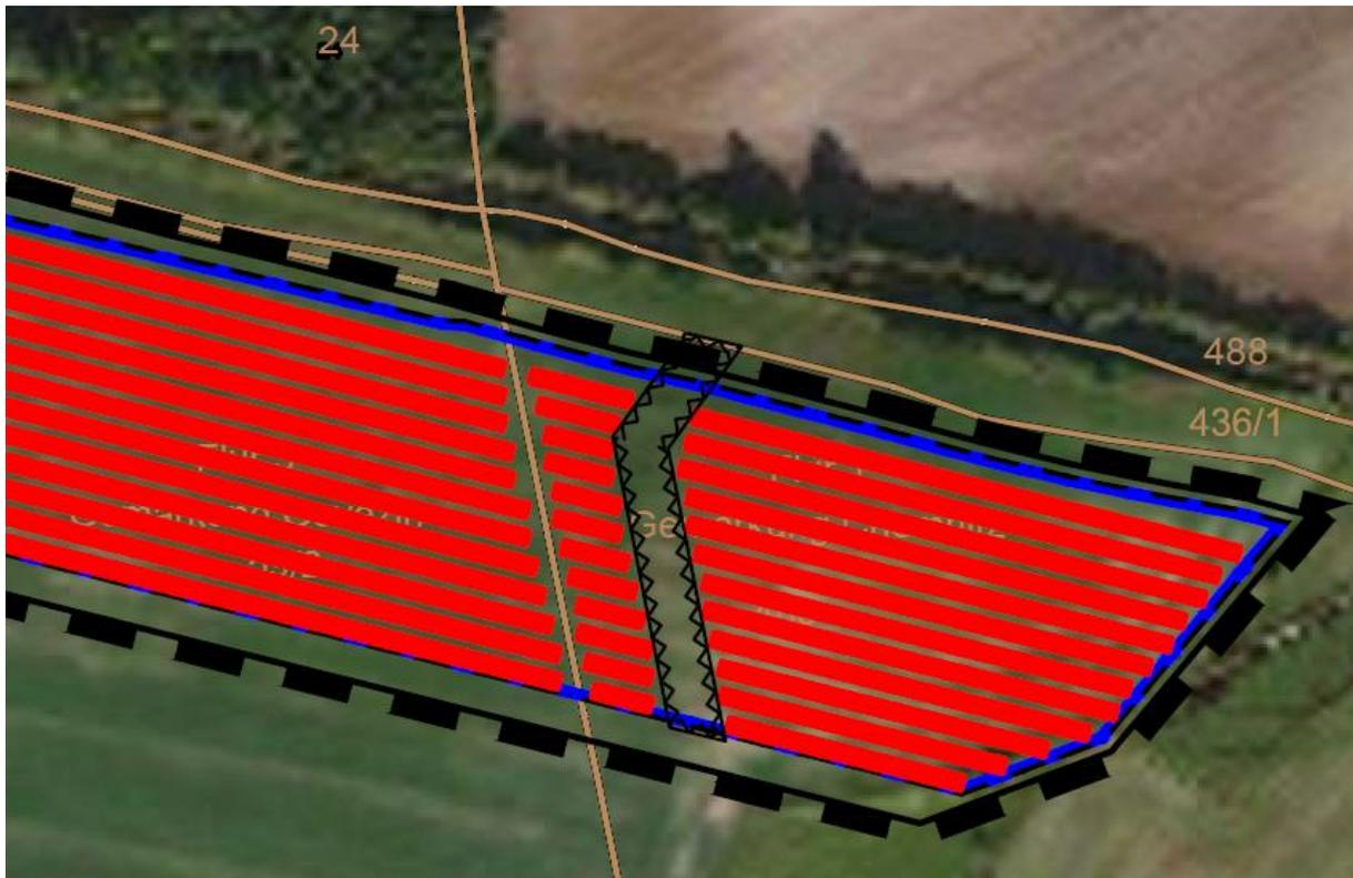
Abbildung 3: PV-Anlage A1/A2: Belegungsbeispiel der geplanten PV-Module und Tischreihen (Quelle: Auftraggeber)
