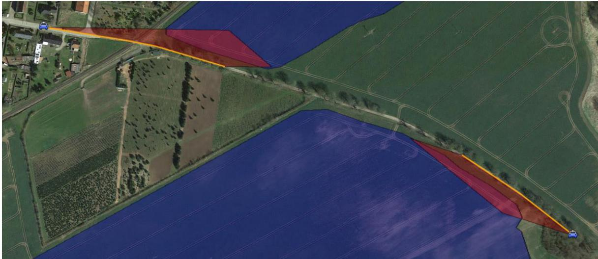
Abbildung 16: Von potenzieller Blendung betroffener Streckenabschnitt des Feldwegs in Orange, PV-Fläche in Blau und betroffener Sichtbereich in Rot
