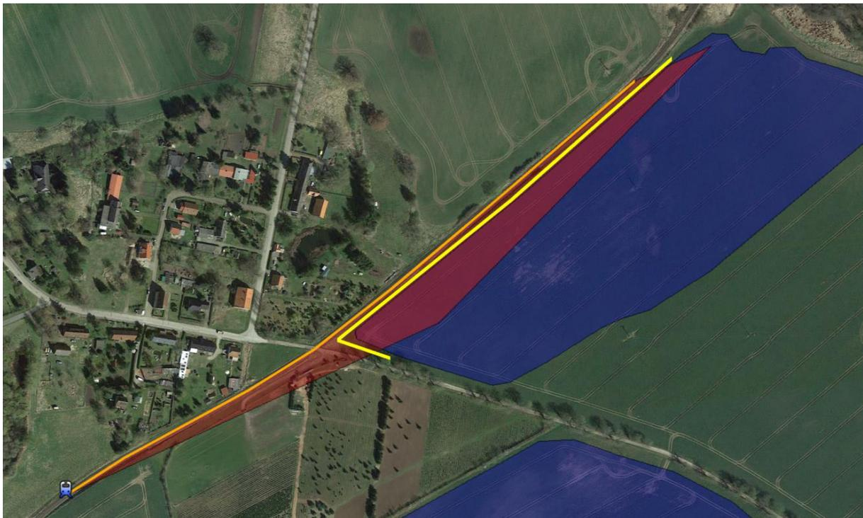
Abbildung 19: Empfohlener Blendschutz in Gelb, betroffener Streckenabschnitt der Bahntrasse in Orange
