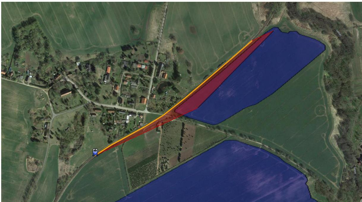
Abbildung 14: Von potenzieller Blendung betroffener Streckenabschnitt der Bahntrasse in Orange, PV-Fläche in Blau und betroffener Sichtbereich in Rot
