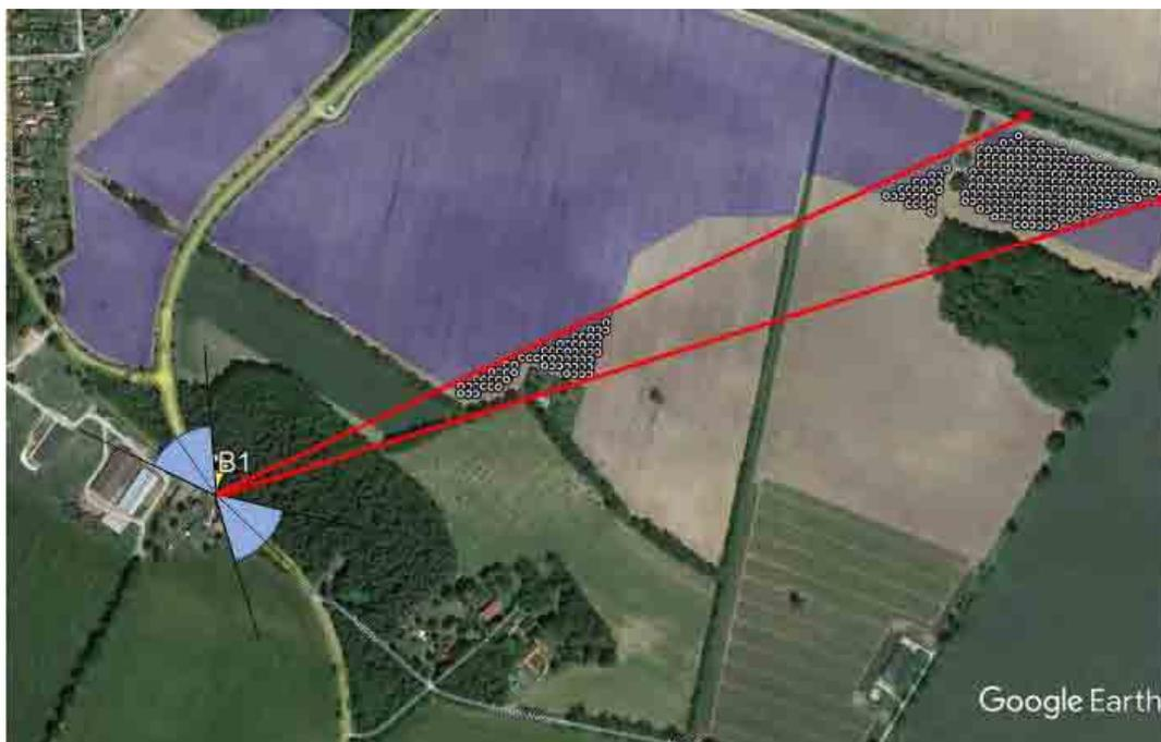
Abbildung 32: Vergleich Sichtfeld Fahrzeugführer zu Punkt B1 mit Grenzvektoren in Richtung Module
