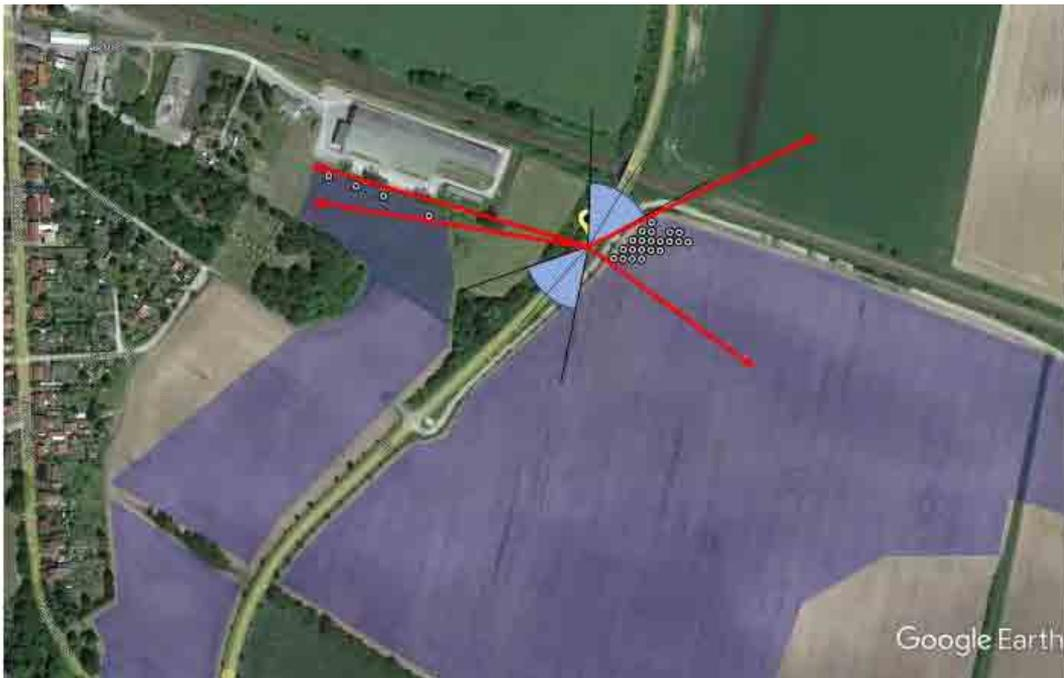
Abbildung 38: Vergleich Sichtfeld Fahrzeugführer zu Punkt B5 mit Grenzvektoren in Richtung Module
