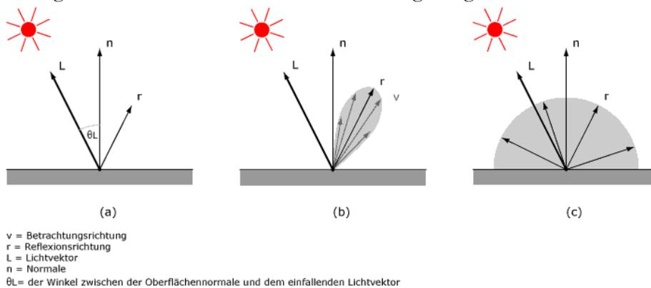
Bild 3.2.4: Diffuse Reflexion von unterschiedlichen Moduloberflächen (© Jürgen Hagler)
