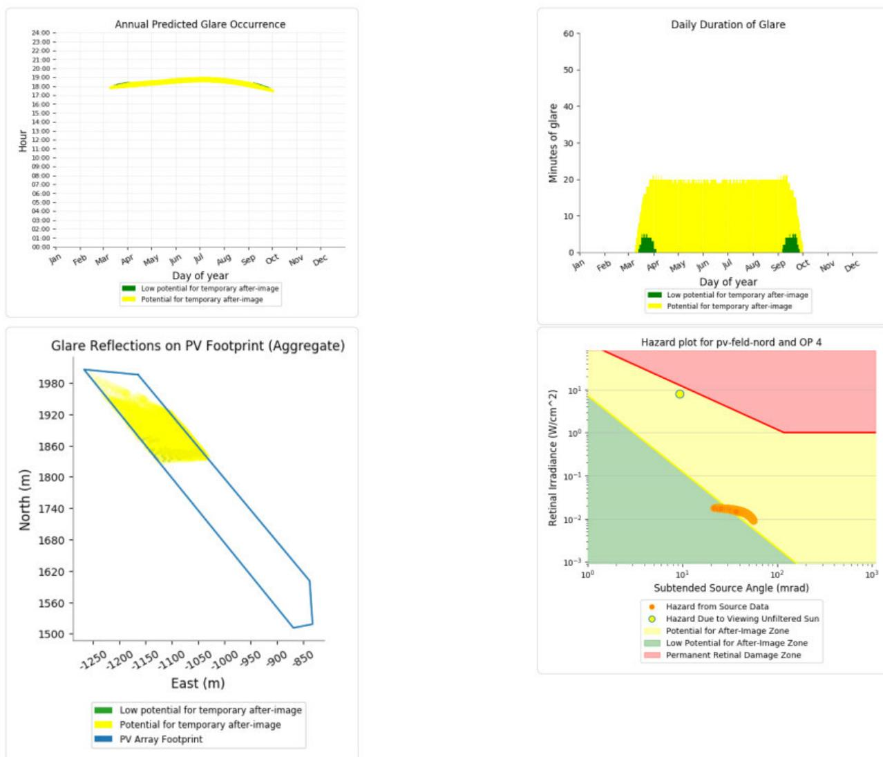
Bild 4.4.2: Ergebnisdetails für Messpunkt P4 (Quelle: Simulationsergebnisse)
