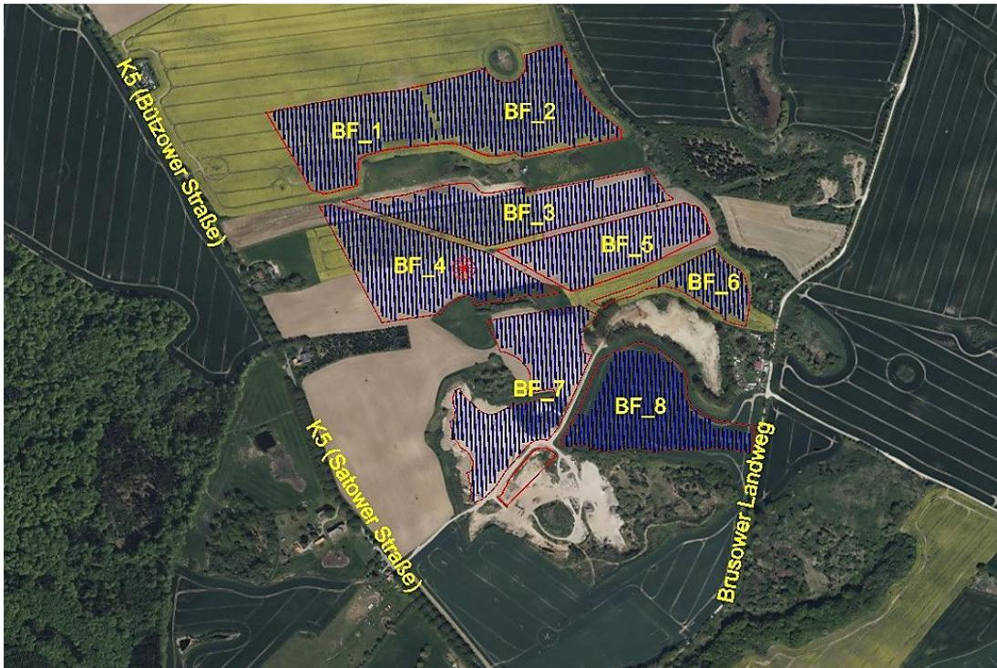
Abbildung 6: Belegungsplan der PV-Anlage (Modultischreihen in blau, Baugrenzen in rot)
