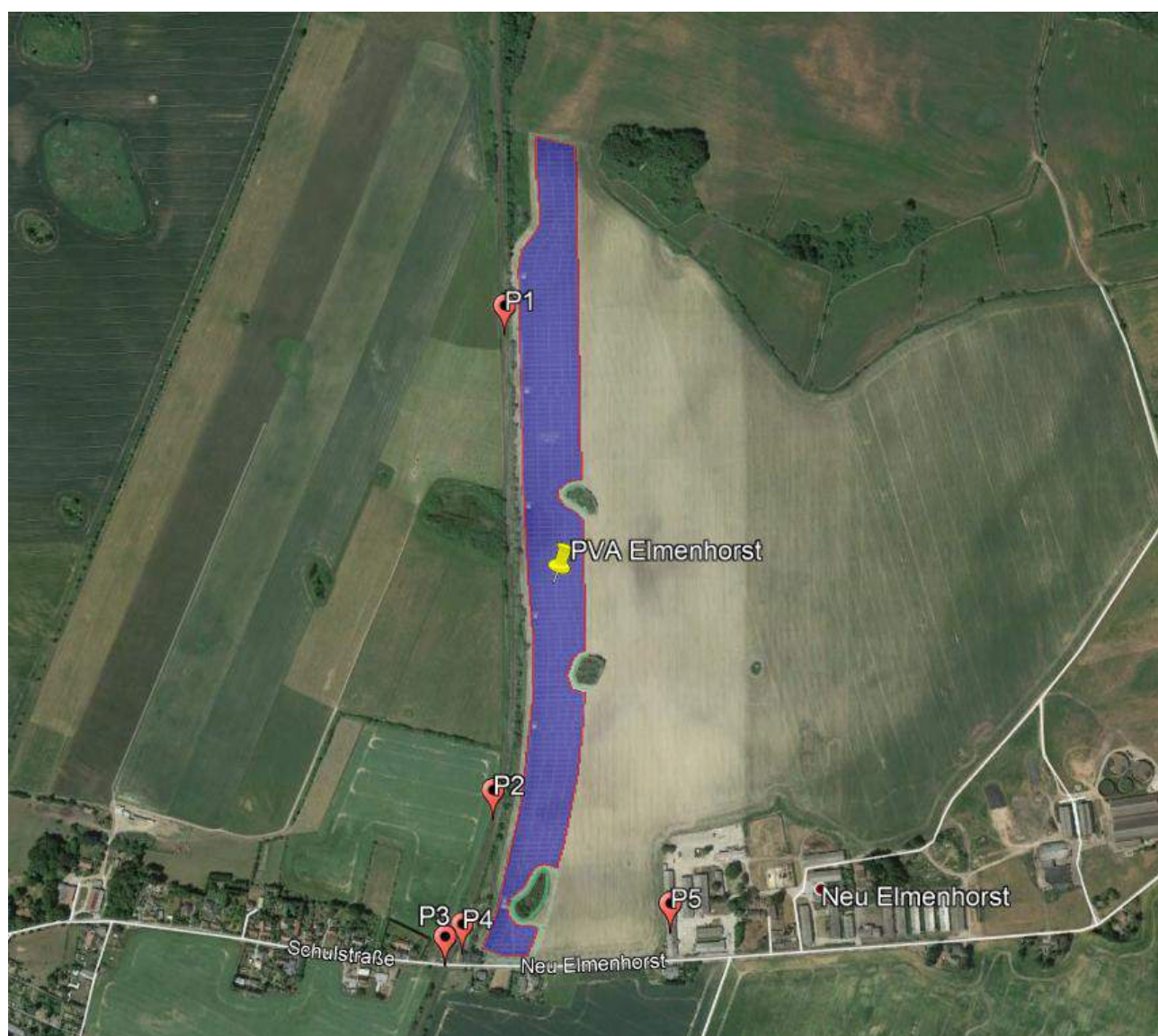
Bild 3.5.1: Exemplarisch gewählte Messpunkte (P1 - P5) für die Analyse der Reflexionen (Quelle: Google Earth/SolPEG)
