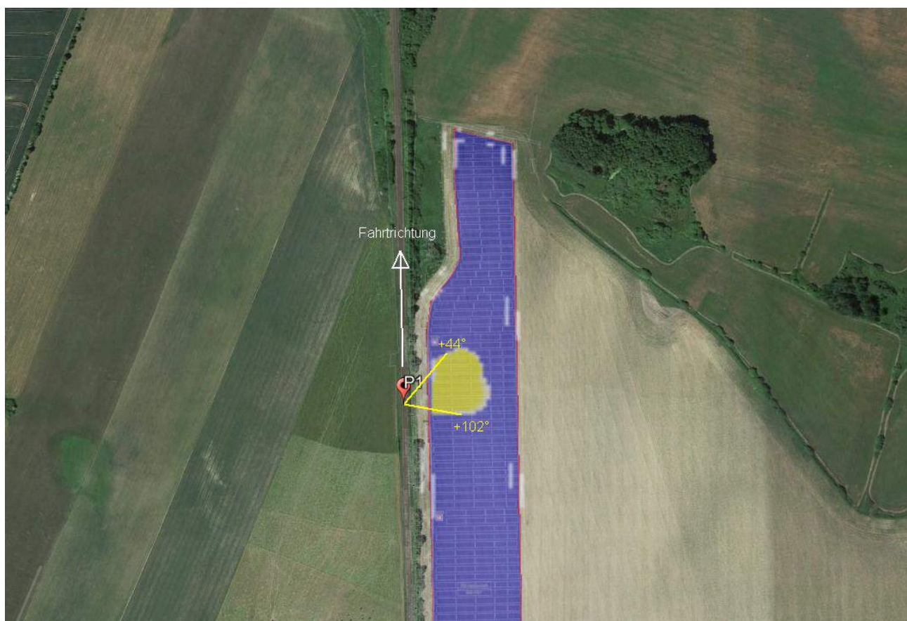
Bild 4.2.1: Potentielle Reflexionen am Messpunkt P1 (Quelle: Google Earth / SolPEG)
