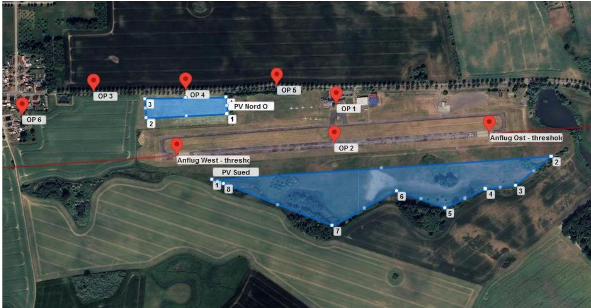
Abbildung 9: In Simulation definierte PV-Felder (blau), Immissionspunkte und Flugrouten (rot)
