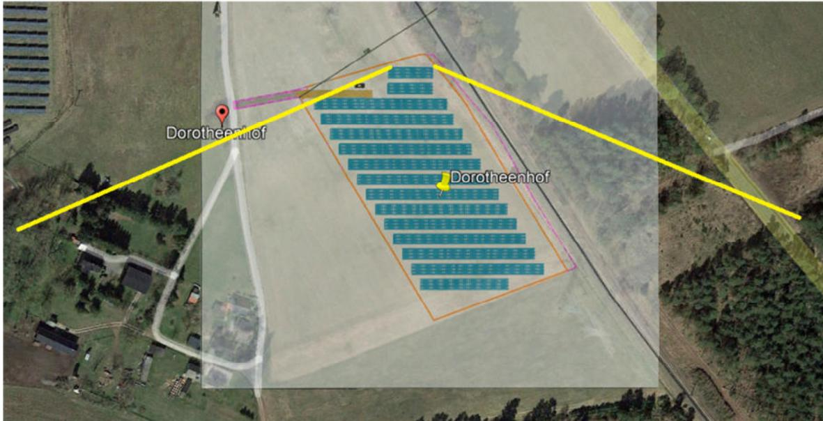
Abbildung 9: max. Auslenkung der Reflektion [Google Earth]
