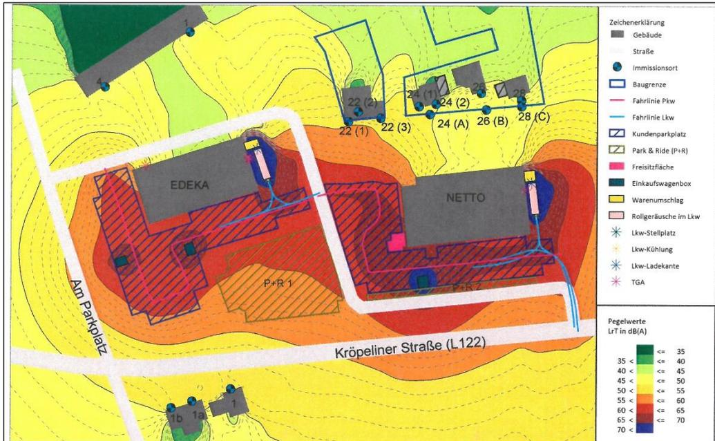
Abbildung 8 Beurteilungspegel gemäß TA Lärm | 06:00 - 22:00 Uhr | Höhe über Gelände: 2 m | Planfall
