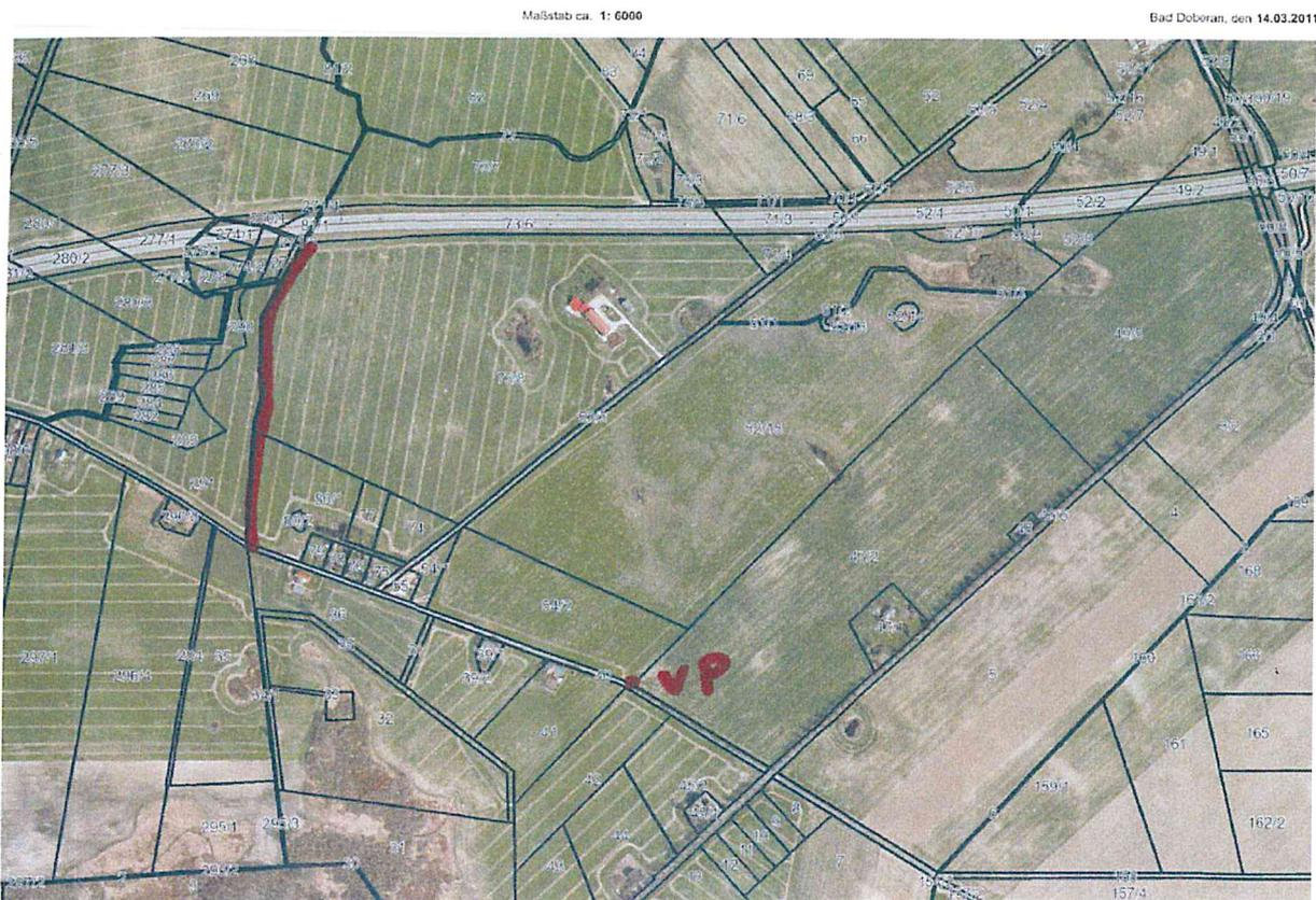
Geplanter Trassenverlauf des Einspeisekabels (Übersichtsplan o.M.)
