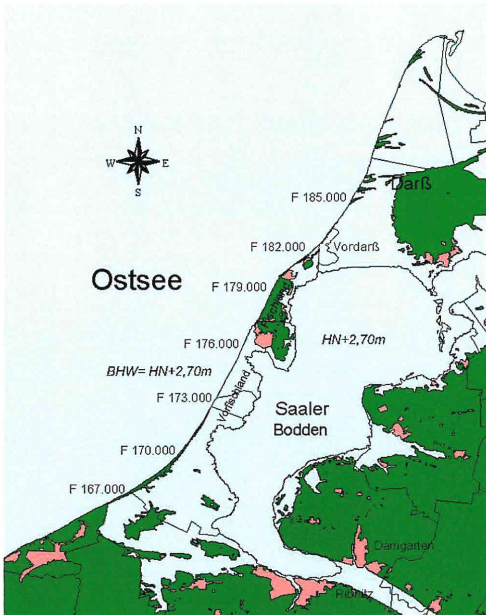
Abbildung 3: Überflutungsbereiche bei Eintreten einer Bemessungsturmflut und gleichzeitigem Versagen der vorhandenen Küsten- und Sturmflutschutzanlagen (StAUN 2003)
