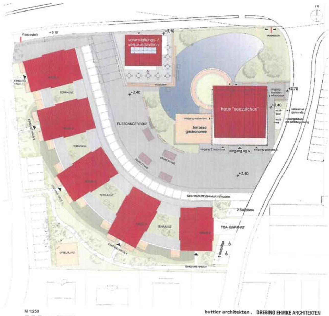
Abbildung 5: Wettbewerbsergebnis: überarbeiteter Lageplan mit Tiefgarage und durchgehender Platzfläche
