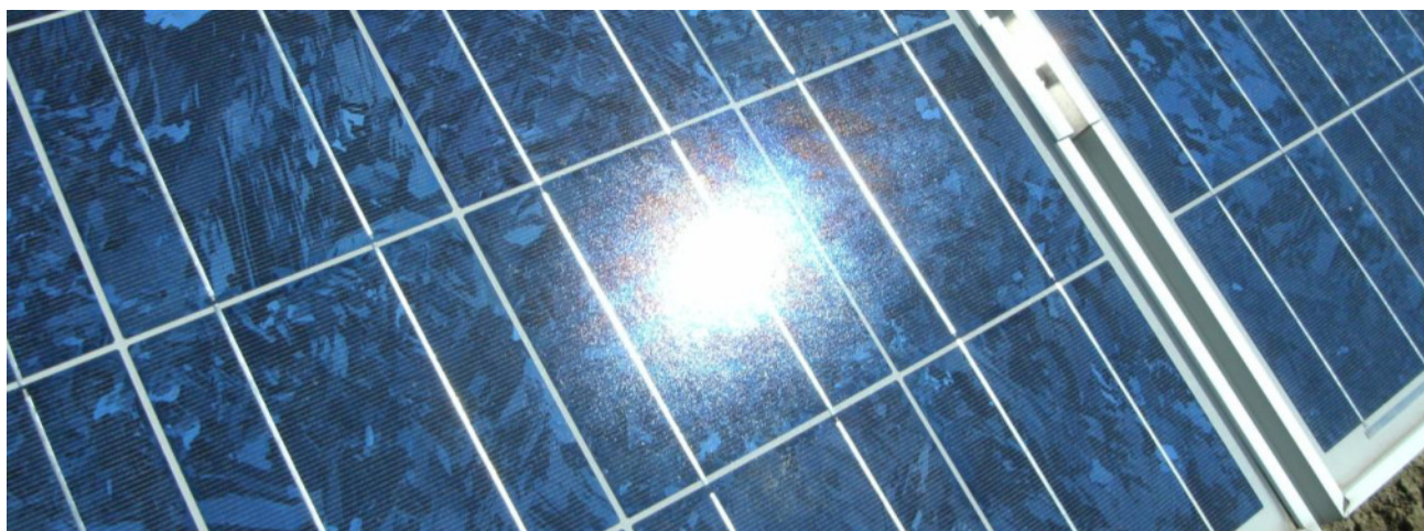
Bild 3.2.2: Diffuse Reflexion von direkten Sonnenlicht (Einstrahlung ca. 980 W/m²) auf einem PV Modul (Quelle: SolPEG)
