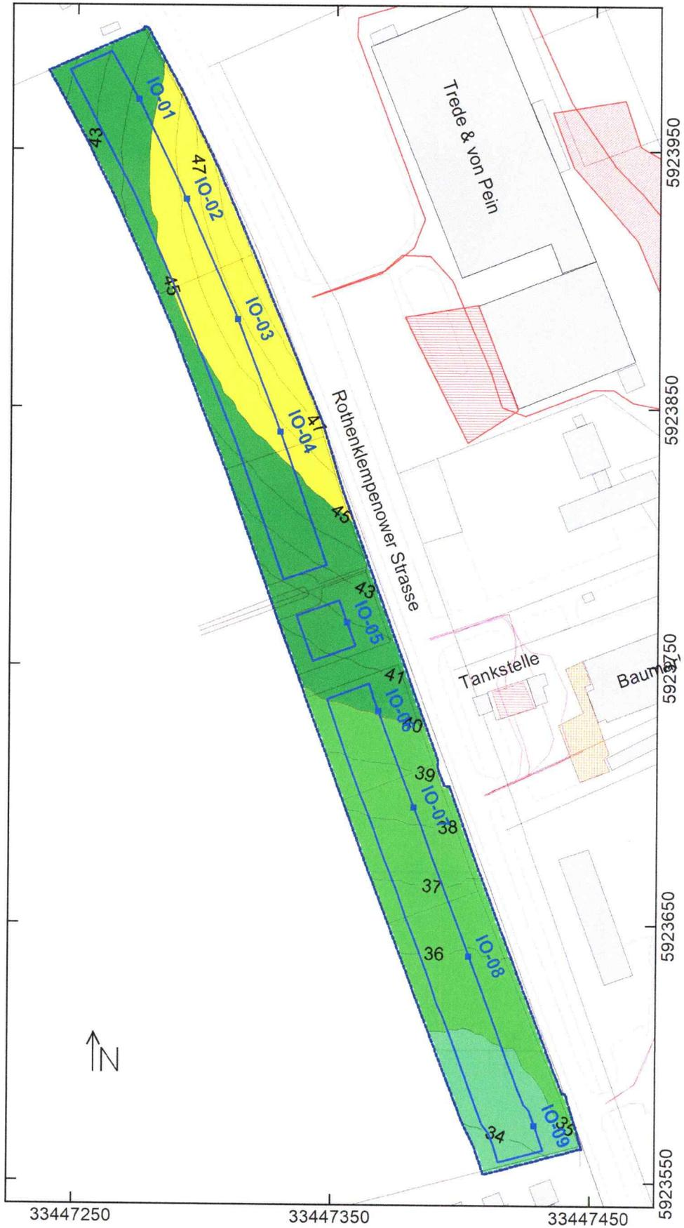
Anlage 7 : Beurteilungspegel Tag (Getreideeinlagerung in Halle bis 20:00 Uhr)
