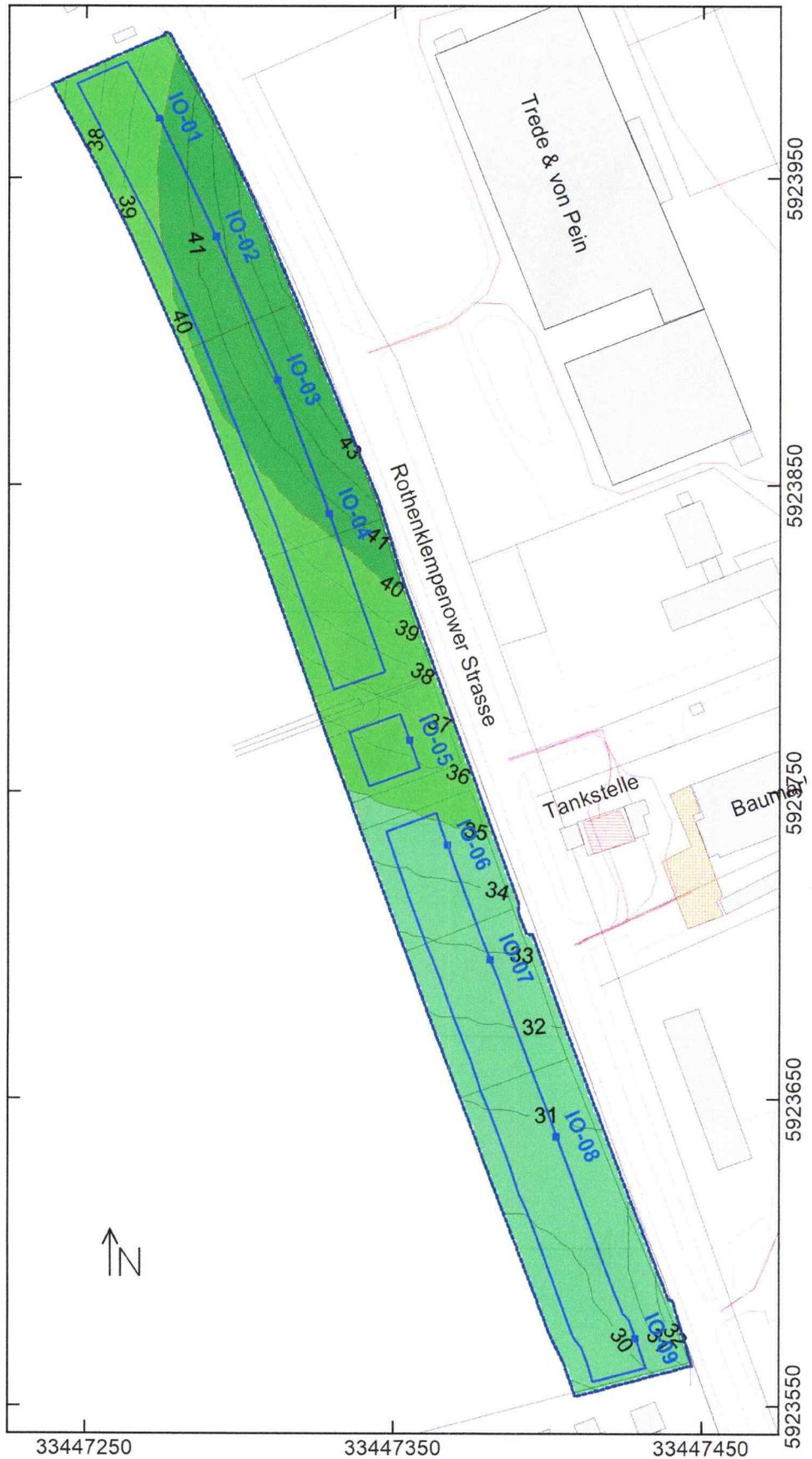
Anlage 19 : Beurteilungspegel Tag (Getreidebelüftung in den Hallen und im Außenbereich)
