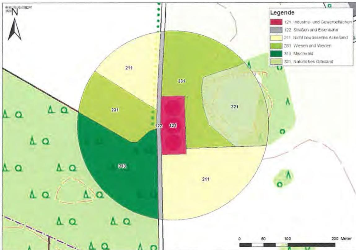
**Abb. 5: Rauigkeitsklassen entsprechend dem CORINE-Kataster im Umfeld der geplanten Gärrestbehälter** (Quelle: GeoBasis-DE/M-V 2018)
