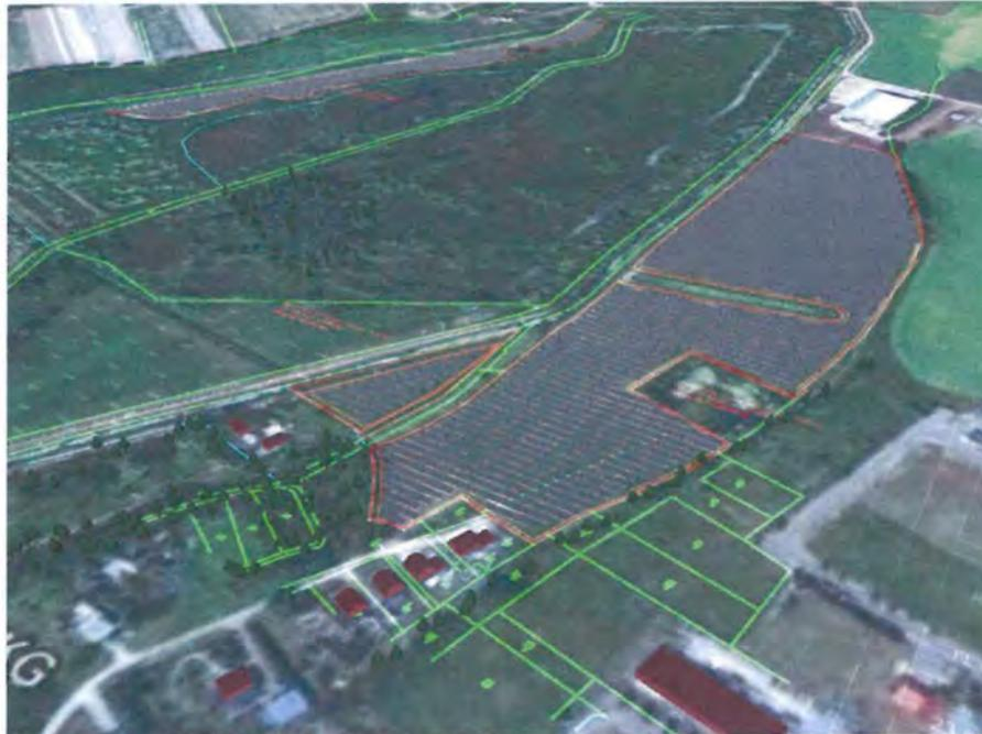
Abbildung 1: Satellitenbild mit eingebetteten Modulbelegungsplan des Anlagenstandortes mit GoogleEarth
