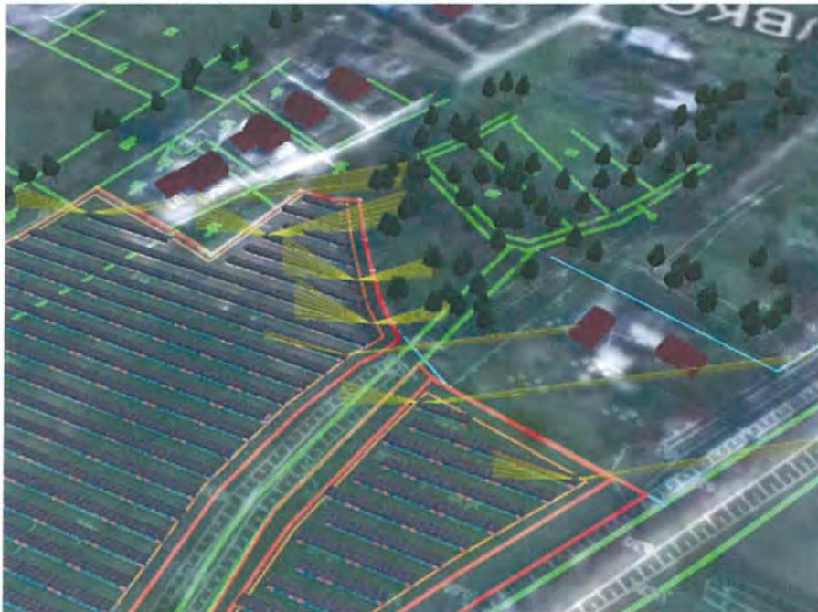
**Abbildung 7: Visualisierung des Blendverhaltens in der Übersicht am Tag des Sonnenhöchststandes aus Nord Morgens**
