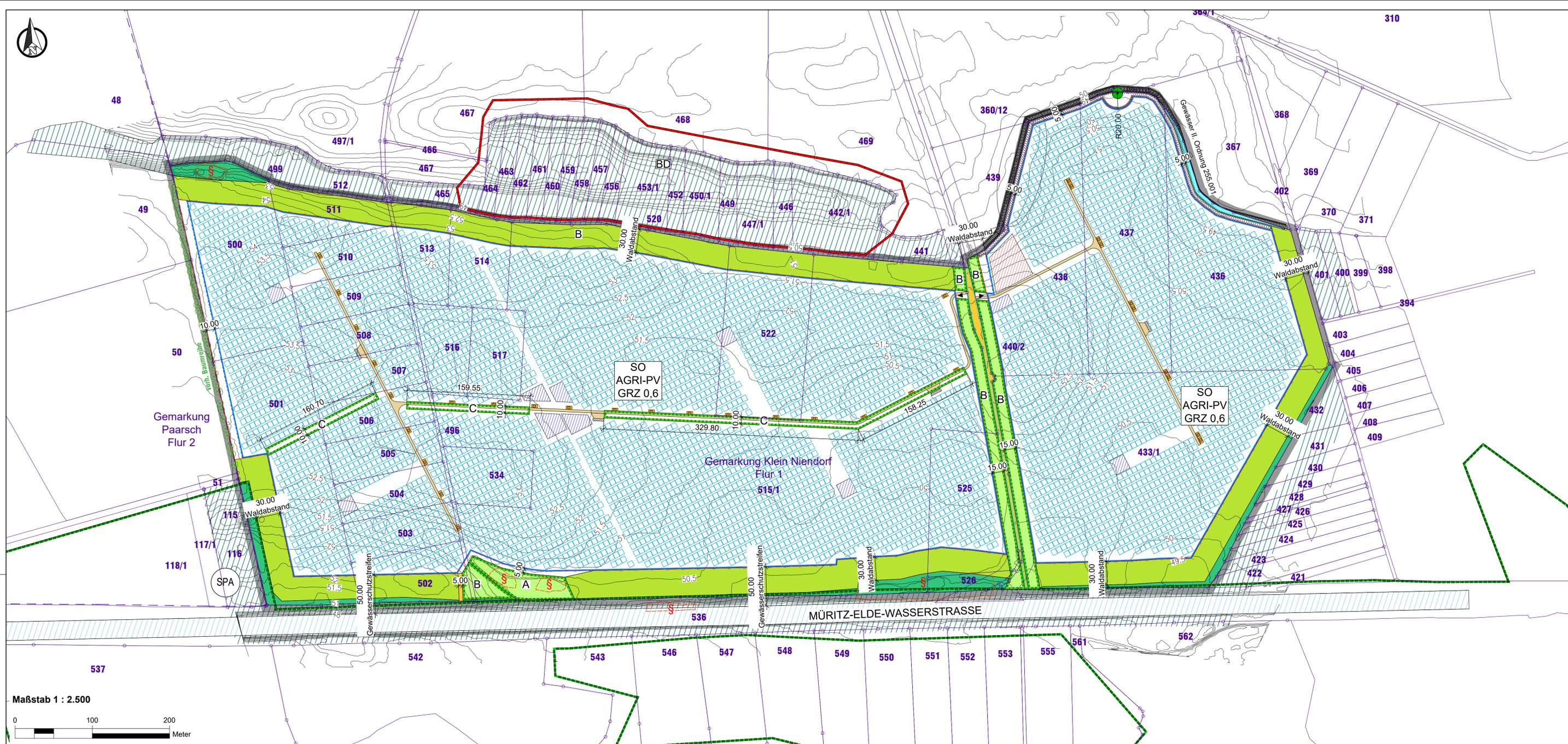
Für die geplante AGRI-PV-Anlage der Kategorie I (Aufständiger mit lichter Höhe) nach Tabelle 1 der DIN SPEC 91434:2021-05 werden zur Überschirmung der Austauschflächen linienförmig aneinandergereihte Module verwendet, die auf geramten Stahl-Unterkonstruktionen gegen Süden platziert werden. Die Darstellung der Modulreihen erfolgt innerhalb des Vorhaben- und Erschließungsplanes schematisch.
