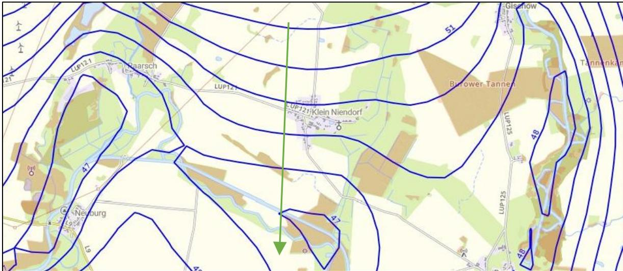
**Abbildung 8:** Übersichtskarte zur Grundwasserfließrichtung auf Basis der digitalen topographischen Karte (Gaia M-V), grüner Pfeil zeigt die Fließrichtung
