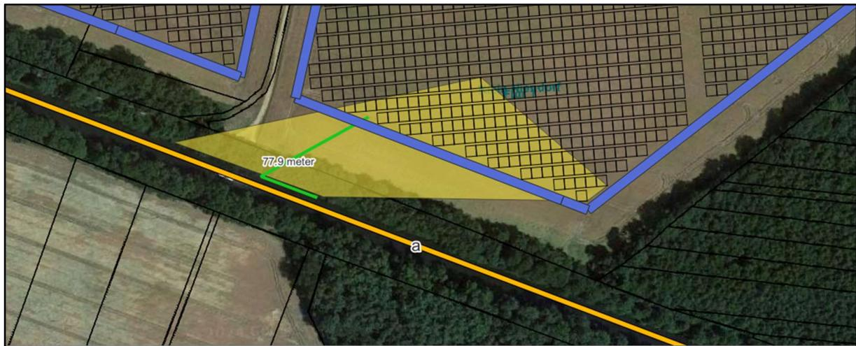
Abb. 17: zeigt die potentielle Reflexionsbereiche des ostlichen Anlagenteils (gelb); schwarze Rechtecke = geplante Modultische; grune Winkel = 50° Sichtachse aus Wasserfahrzeug mit geringster Entfernung zu den nachstgelegenen Modulen; blau = Grenze d. Baufeldes
