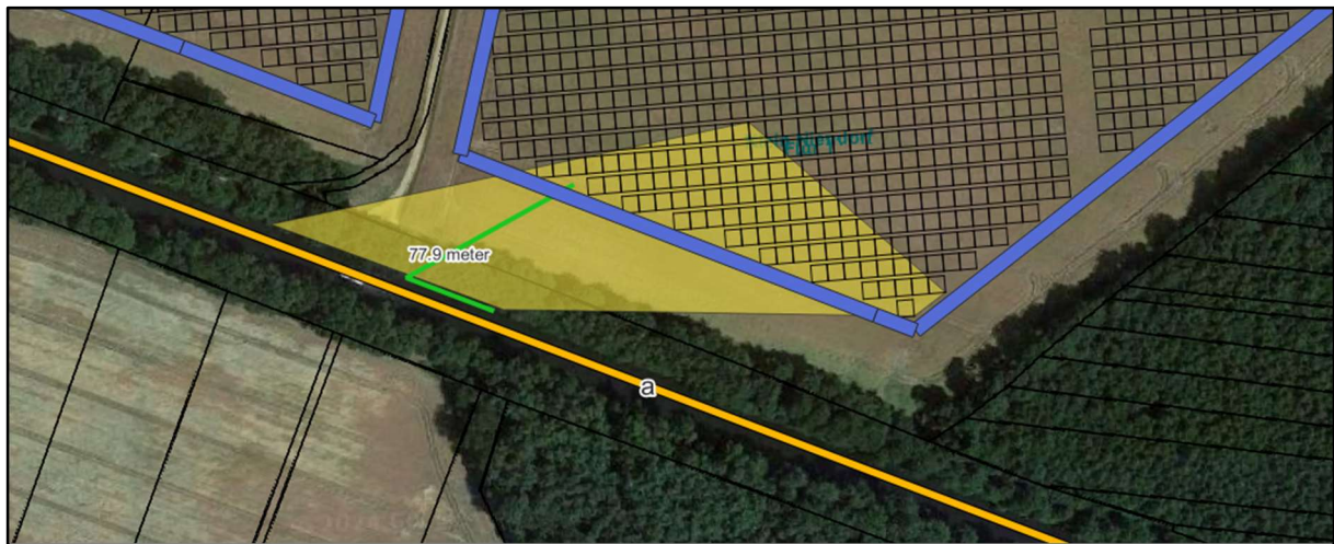
Abb. 17: zeigt die potentielle Reflexionsbereiche des östlichen Anlagenteils (gelb); schwarze Rechtecke = geplante Modultische; grüne Winkel = 50° Sichtachse aus Wasserfahrzeug mit geringster Entfernung zu den nächstgelegenen Modulen; blau = Grenze d. Baufeldes
