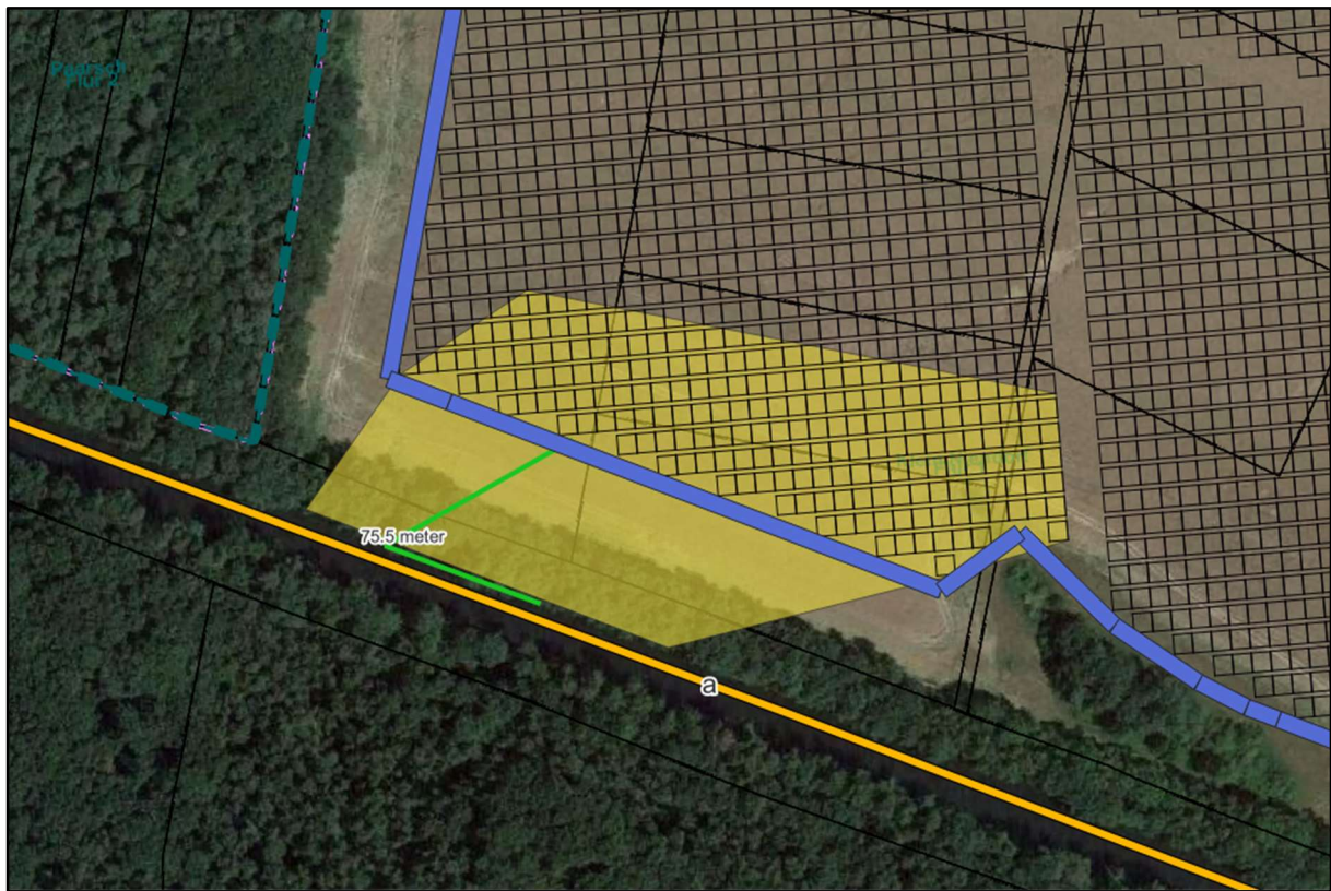
Abb. 13: zeigt die potentielle Reflexionsbereiche des westlichen Anlagenteils (gelb); schwarze Rechtecke = geplante Modultische; grüne Winkel = 50^\circ Sichtachse aus Wasserfahrzeug mit geringster Entfernung zu den nächstgelegenen Modulen; blau = Grenze d. Baufeldes
