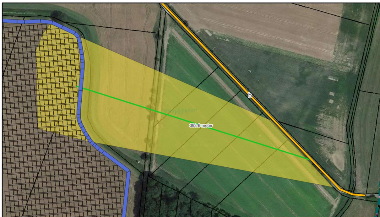
Abb. 20: zeigt die potentielle Reflexionsbereiche von Baufeld 2 auf die Gemeindestraße (gelb); schwarze Rechtecke = geplante Modultische; grüne Winkel = 30° Sichtachse aus Fahrzeug mit geringster Entfernung zu den nächstgelegenen Modulen; blau = Grenze d. Baufeldes
