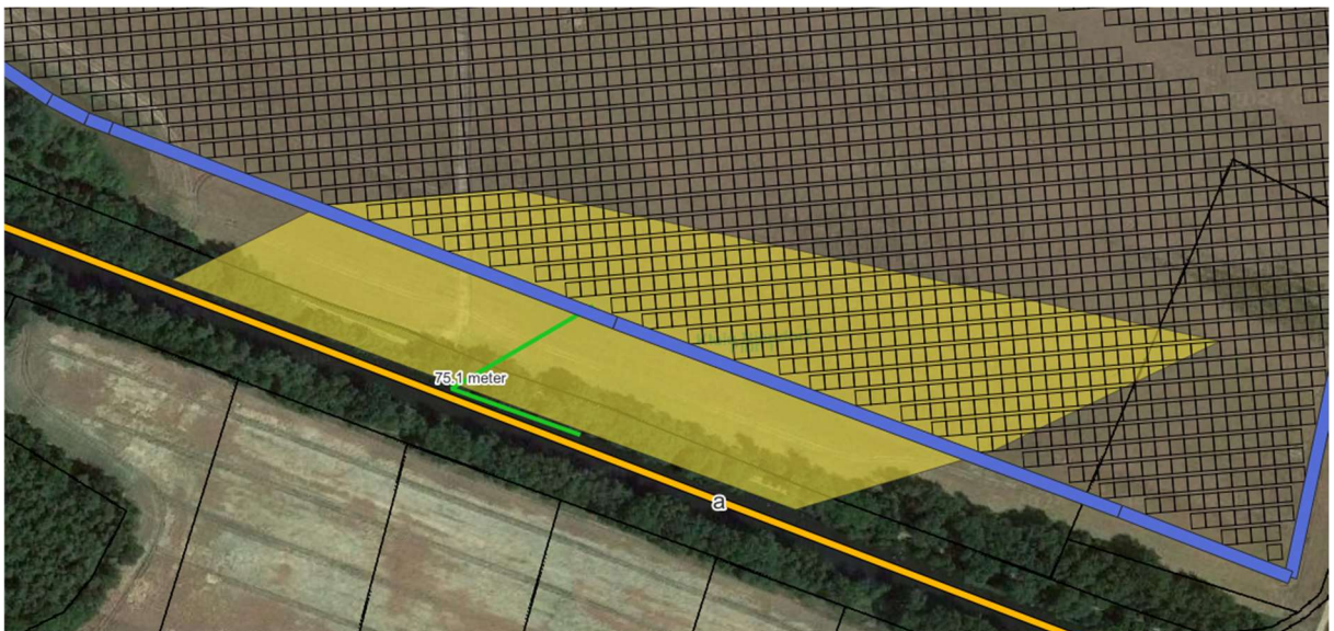
Abb. 14: zeigt die potentielle Reflexionsbereiche des zentralen Anlagenteils (gelb); schwarze Rechtecke = geplante Modultische; grüne Winkel = 50^\circ Sichtachse aus Wasserfahrzeug mit geringster Entfernung zu den nächstgelegenen Modulen; blau = Grenze d. Baufeldes
