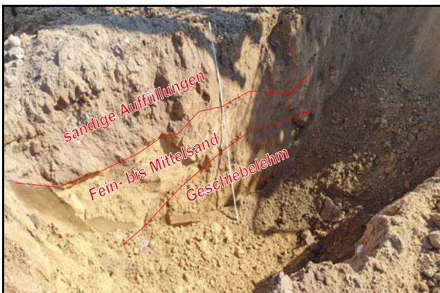
Abb. 5: 2 m tiefer Baggerschurf auf der Teilfläche 3
