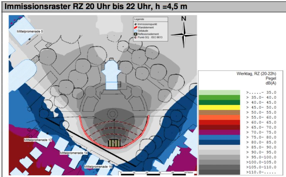
Abb. 17: Immissionsraster – Variante 4 mit LS-Wand (Glas), Bühne tiefer, Zeltdach
