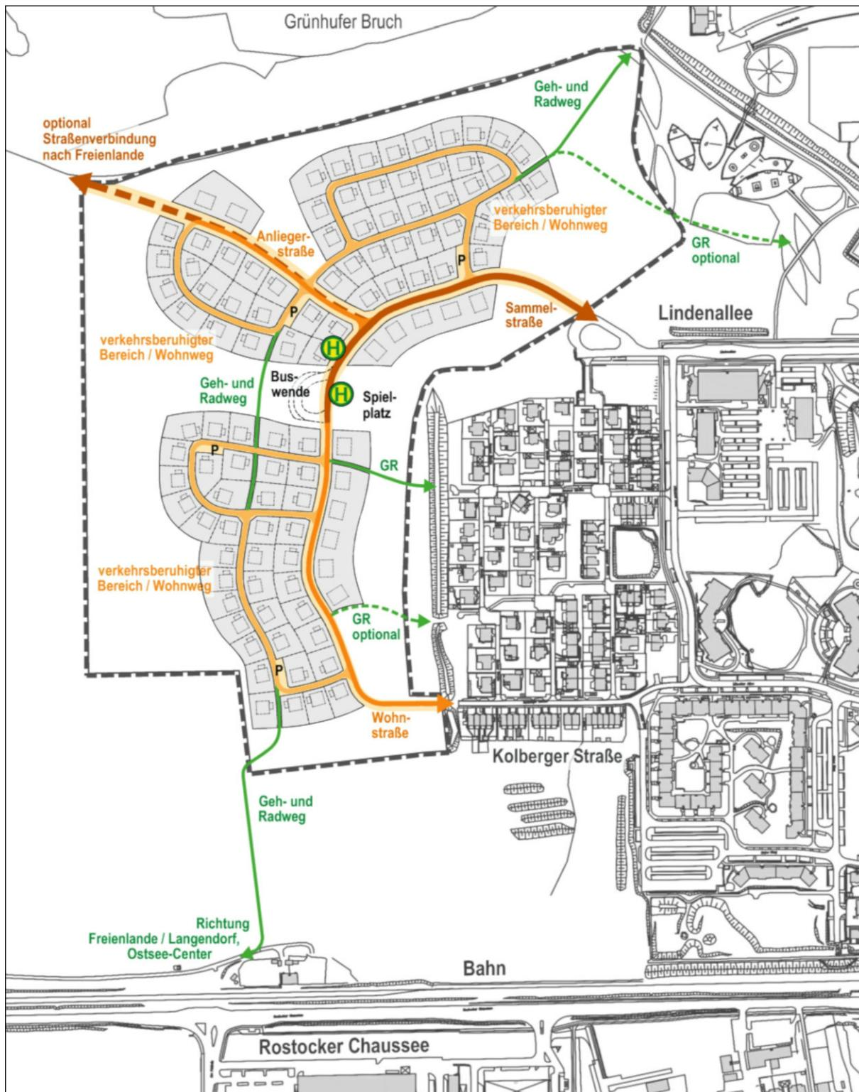
Abbildung 2: Übersichtsplan der Verkehrserschließung (Maßstab ca. 1:5000 bei A4)
