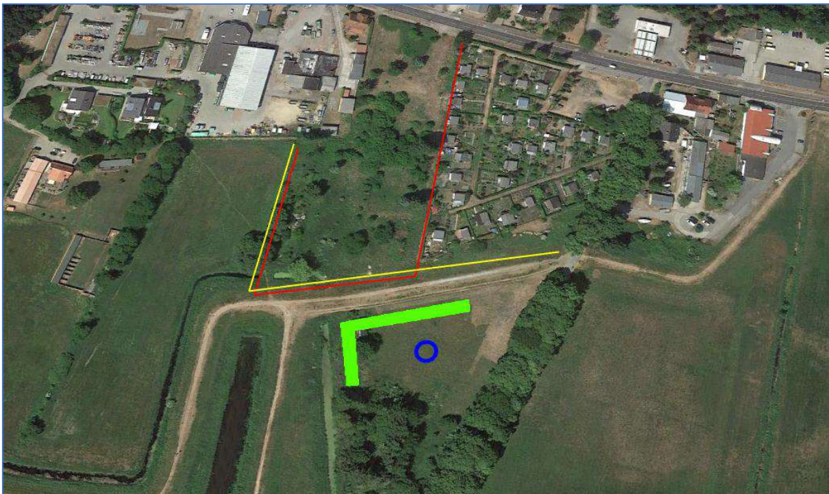
Abb. 5 Amphibienschutzzaun ab März bis Ende April (rot) Amphibienschutzzaun ab Mai bis Bauende (gelb) Kleingewässer (blau) Hecke/ Gebüschfläche mit Steinschüttung/ Trockenmauer (grün)
