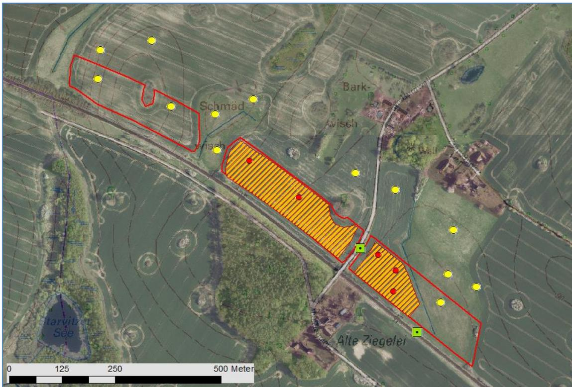
Abbildung 1: Planung der FF-PVA mit Lage der Solar-Module (orange Schraffur)
