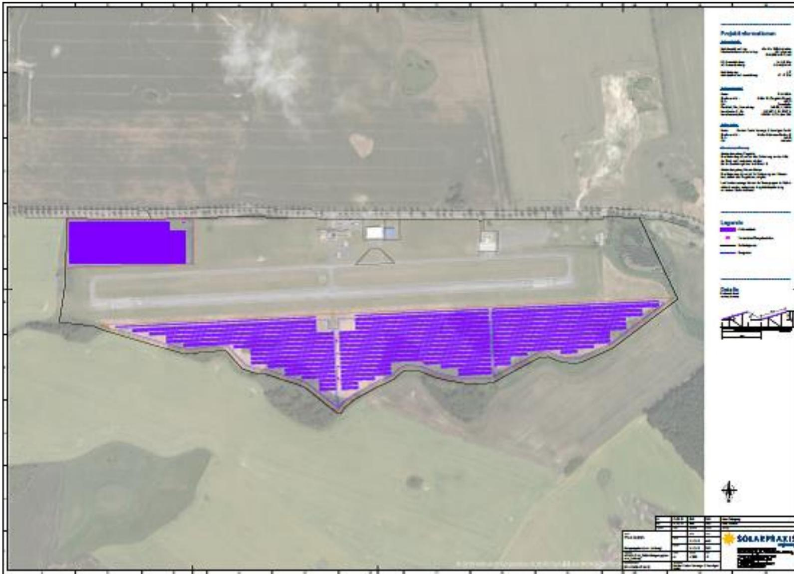
Abbildung 3 Belegungsplan der geplanten PV-FFA Gütting (Planungsstand 11.12.2019, Solarpraxis Engineering GmbH)
