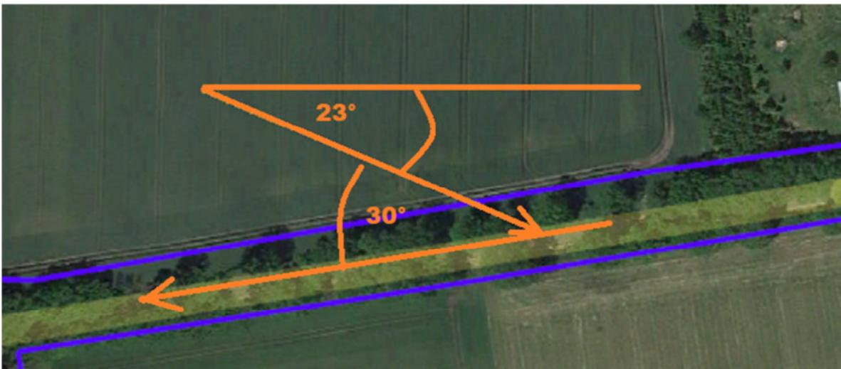
Abbildung 10: Maximal möglicher Einfallswinkel der Reflektionsstrahlen [Quelle: Google Earth, eigene Berechnungen]
