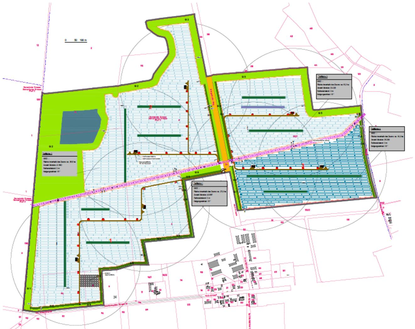
Abbildung 6 Vorläufiger Belegungsplan (Stand 02/2025) mit Darstellung Löschwasserzisternen, Darstellung ist unverbindlich
