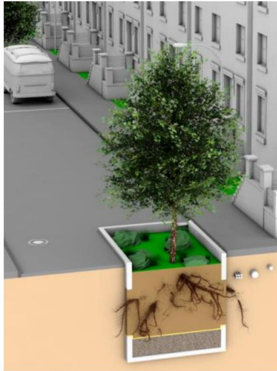
Schema einer Baum-Rigole (Quelle: Sieker)
