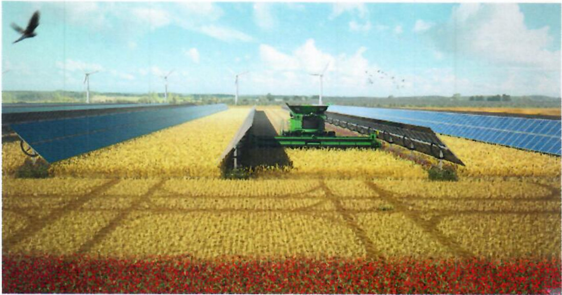
Prinzip-Darstellung: Agri-PV mit einachsigen Trackern auf Ackerland (Quelle: EWS)
