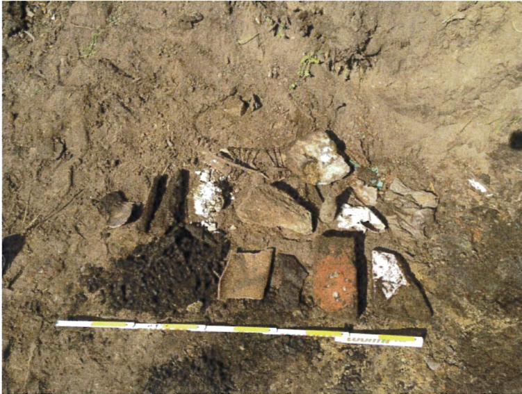
*Bild 2: Aus der Aufschüttung des Probeschurfes 1 separierte grobstückige Bestandteile (untere Reihe von links nach rechts: Holz, Asbestzement, Teerpappe, Ziegel, Fliese obere Reihe von links nach rechts: Metall, Holz, Kalk, Beton, Glas, Kunststoff).*
