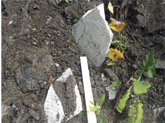
Bild 5: Haldenschnitt mit herausragenden Asbestzementbruchstücken.
