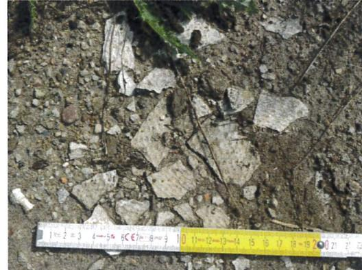
Bild 6: Haldenoberfläche mit Asbestzementbruchstücken.
